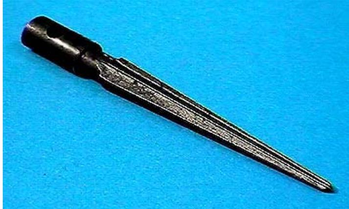
Gambar 6.62. Pemerluas lubang (*reamer*)
