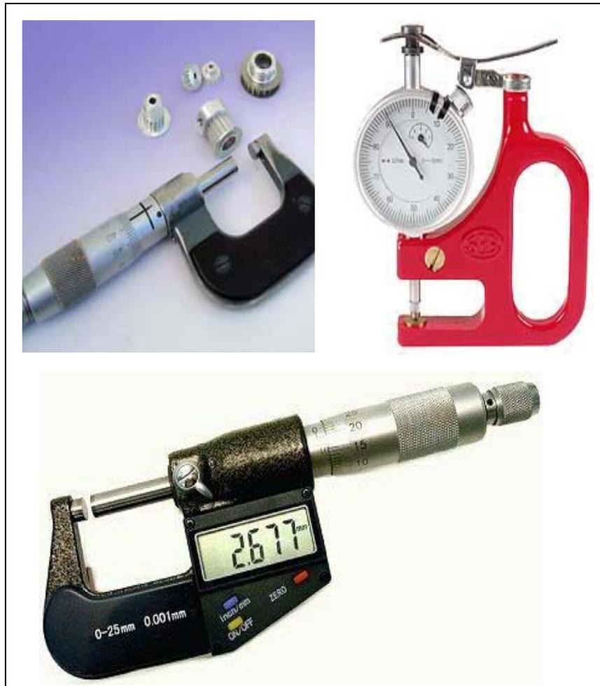
Gambar 5.55. Macam-macam Mikrometer luar
