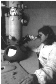
Berdasarkan sifat gelombang elektron bahwa elektron dapat digunakan untuk melihat benda yang sangat kecil. Maka, para ilmuwan membuat mikroskop elektron. Saat ini mikroskop elektron merupakan suatu alat penelitian yang sangat penting. Coba Anda perhatikan gambar disamping yang menggambarkan fitur mikroskop elektron.
