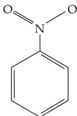
Kelarutan nitrobenzena dalam air sekitar  $0,19\text{ g}/100\text{ mL}$  pada  $20\text{ }^\circ\text{C}$ , titik lelehnya  $5,85\text{ }^\circ\text{C}$ , sedangkan titik didihnya  $210,9\text{ }^\circ\text{C}$ . Nitrobenzena dapat digunakan sebagai pelarut dan bahan baku pembuatan anilina serta digunakan juga dalam produk semir dan senyawa insulator.
