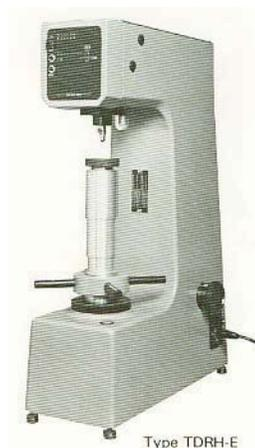
**Gambar 10.15** Konstruksi pesawat uji kekerasan Rockwell
