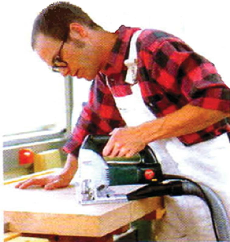
**Gambar 11.8** Membelah/memotong kayu dengan Jig Saw
