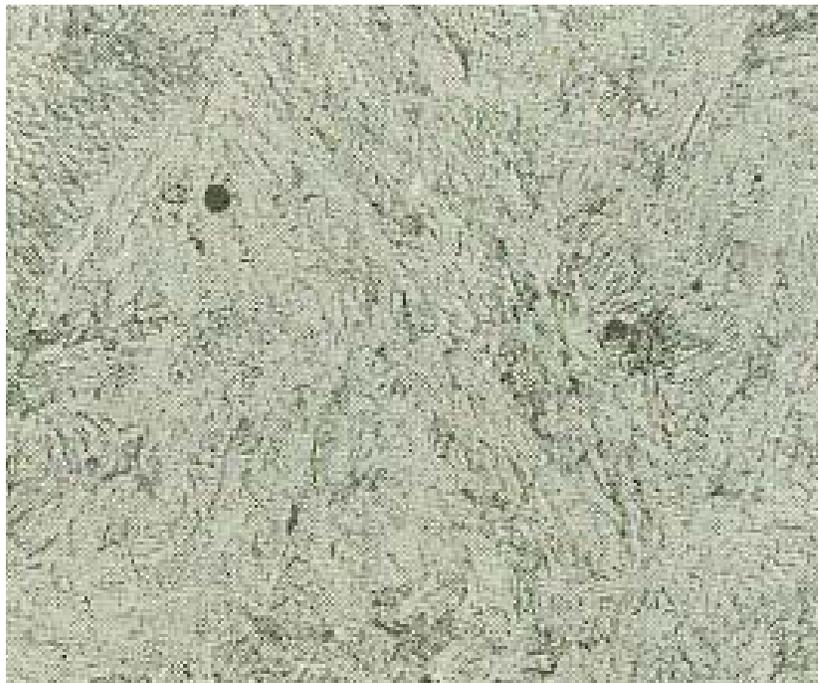
**Gambar 10.67** Struktur martensite dari baja AISI 4340 ditemper dengan temperatur 400<sup>o</sup>F diperbesar 32000 X
