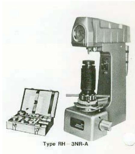
**Gambar 10.14** Konstruksi pesawat uji kekerasan Rockwell
