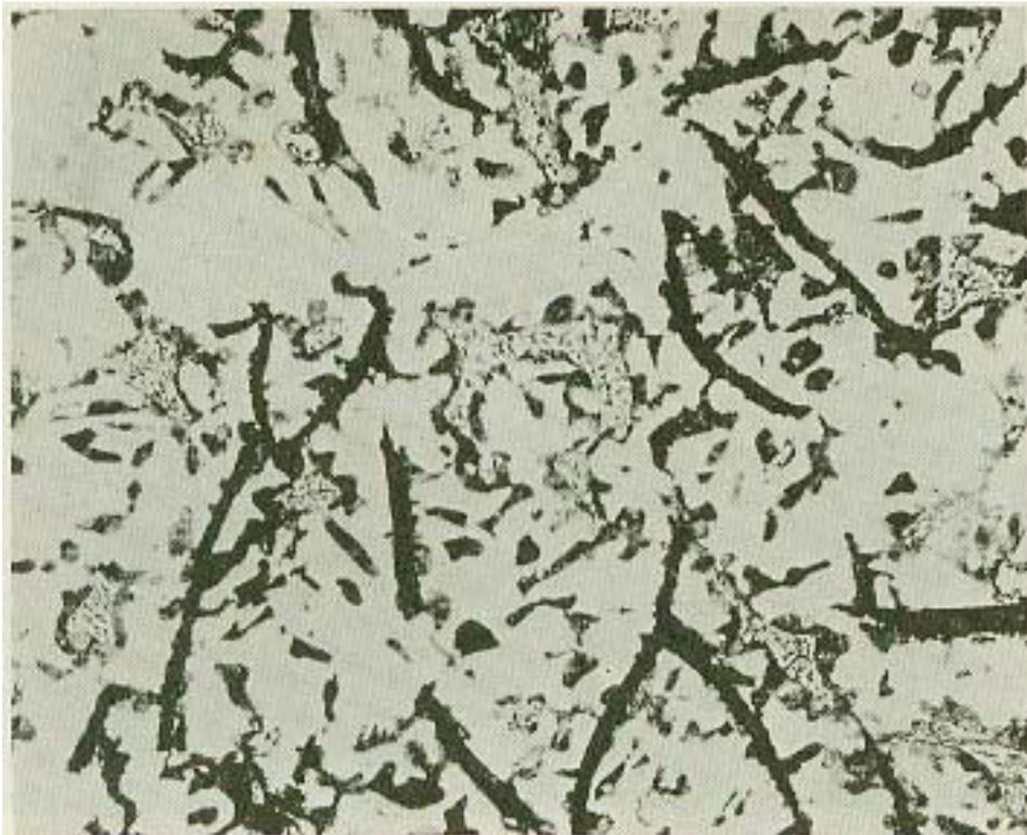
**Gambar 10.59** Microstruktur dari besi tuang (cast iron) setelah pemanasan dan didinginkan dengan udara pembesaran 500X
