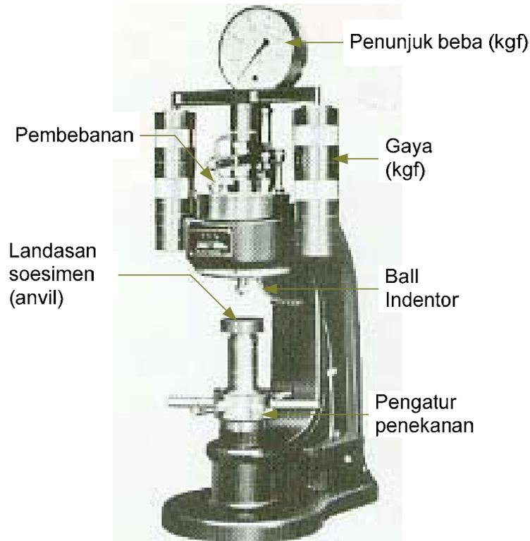
**Gambar 10.4** Mesin uji kekerasan Brinell.
