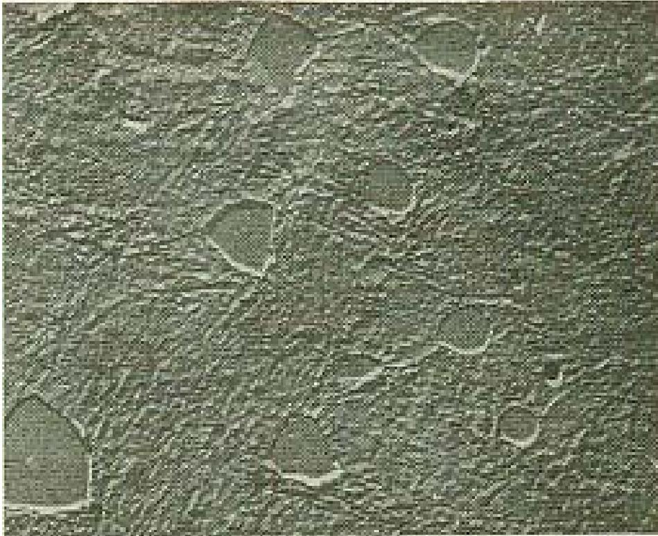
**Gambar 10.68** Struktur baja SAE 52100 setelah proses hardening diperbesar 10000 X
