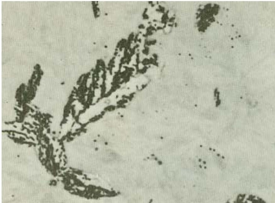
**Gambar 10.65** Struktur dari baja AISI 4340 dalam struktur bainite rendah diperbesar 2000 X
