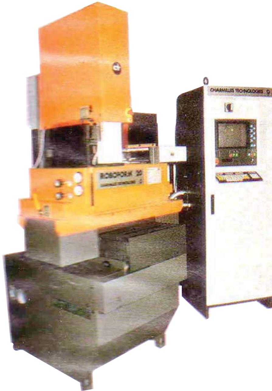
**Gambar 9.105** Mesin EDM yang dikontrol dengan sistem computer.
