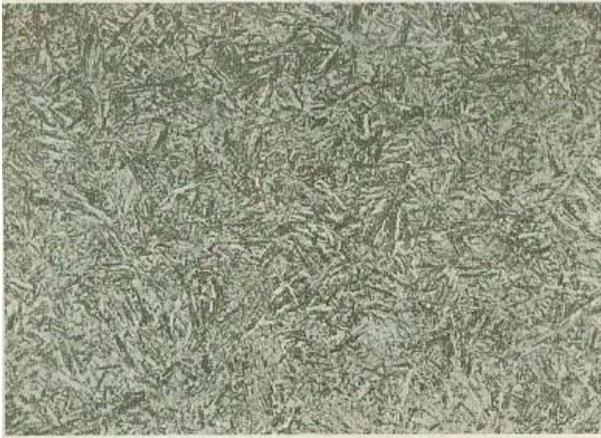
**Gambar 10.64** Struktur dari baja AISI 4340 dalam struktur bainite rendah diperbesar 1000 X
