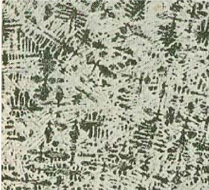
**Gambar 10.62** Standar sample untuk besi tuang putih (white cast-iron) dengan pembesaran 200 X
