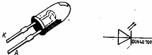
Gambar 1.26. Konstruksi dan simbol LED
