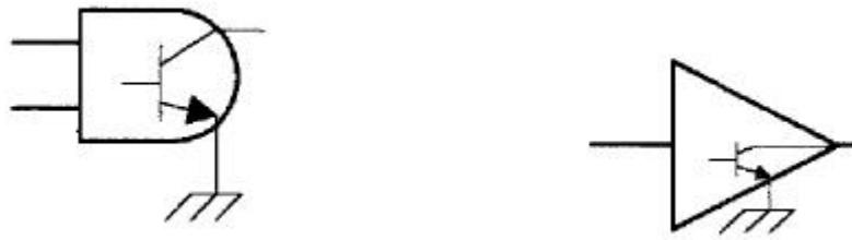
Gambar 9-1. Rangkaian TTL kolektor terbuka (open collector).
